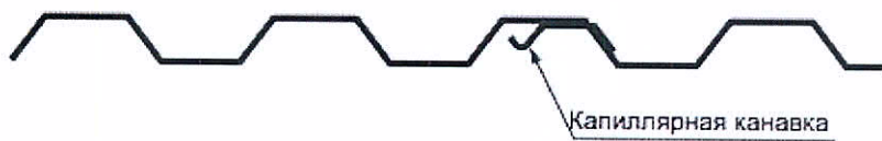
б) Капиллярная канавка в виде отгиба
