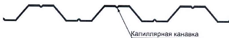
а) Капиллярная канавка в виде гофра жесткости
